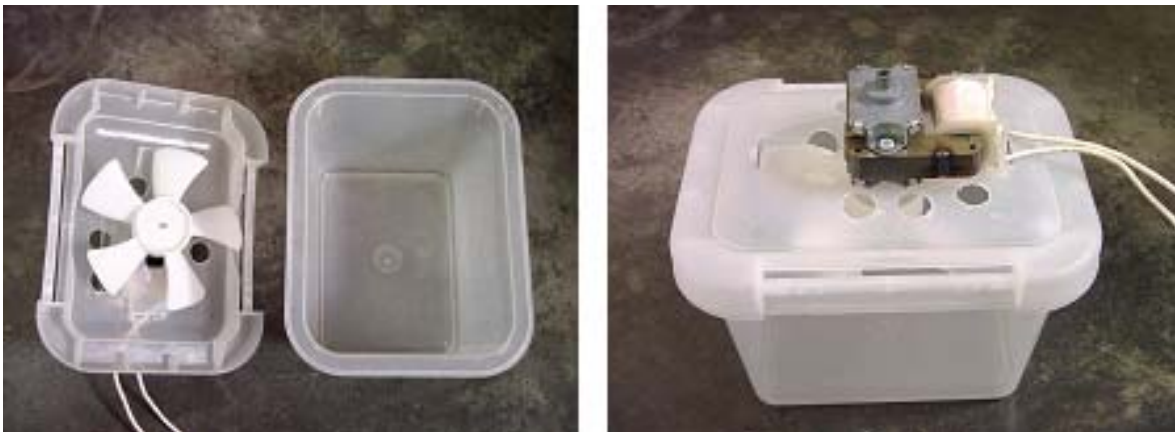
Fig. 16. Dispositivo casero para acelerar la vaporización del formaldehído. Puede ser usado para desinfectar huevos y pequeñas incubadoras antes y después de incubar.
