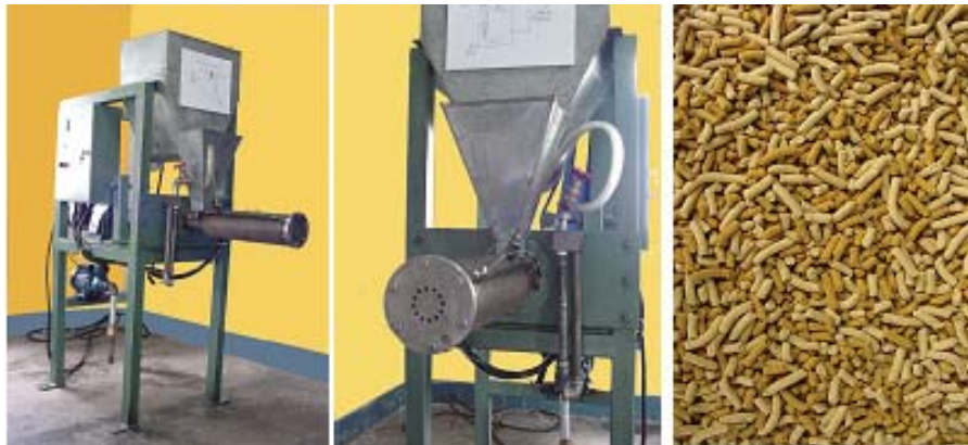
Figura 17. Prototipo de peletizadora. Aspecto general, vista del cañón, y pelets elaborados.
